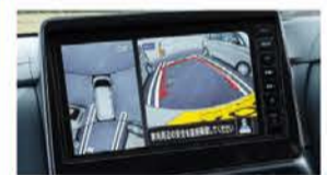
インテリジェント アラウンドビューモニター (移動物 探知機能付) 【グレード別設定】
